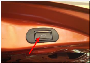
4.3 安装按钮开关 :用我们配的开关底座装上 , 然后开关按钮装上
