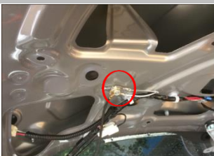
3.9 接负极：松动螺母，卡进负极连接片，卡紧后再还原拧紧螺母，注意拍摄角度
