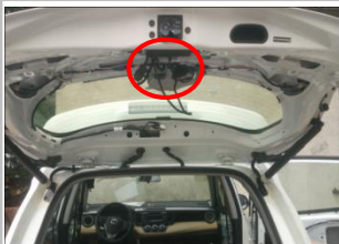
3.5 拆下尾门上盖板，ECU 安装 如图位置 注意如图拍摄角度
