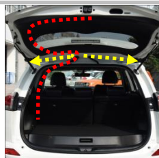
3.3 把驱动盒线、正极线、由下往上沿着波纹管往尾门上穿；撑杆线从中间穿出（黄色）
