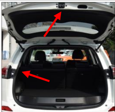
4.4 检查安装的螺钉是否全部锁紧 , 检查所有拆卸的装饰件是否全部锁紧 , 安装完成。
