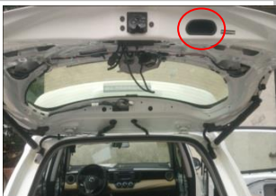
4.2 安装按钮开关 :此处拆下原车塑料件
