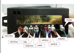
3.4 连接 ECU，待所有线束插好，最后插电源线插头；（插头如前面 ECU 插头说明示意图）
