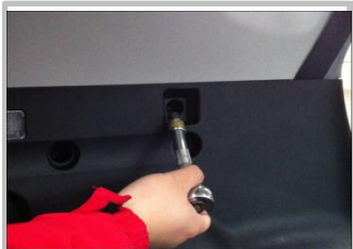
3.13 拆下尾箱内左侧装饰件上的螺钉，并妥善保管
