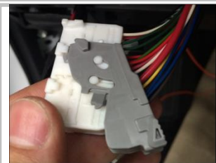
3.19 接正极：方法 1 推一下箭头此处的卡位，然后把灰色塑胶件拆下
