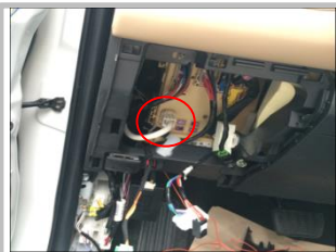
3.24 接正极：方法 2 在驾驶室左边装饰件内找到我们要接的正极电源
