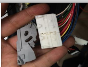
3.20 接正极：方法 1 灰色塑胶件已拆下
