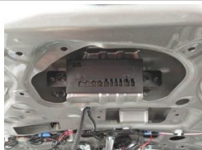
3.6 ECU 上置，注意如图拍摄角度
